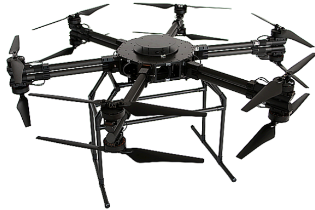
最大離陸重量140kgの重量物運搬用ドローン
